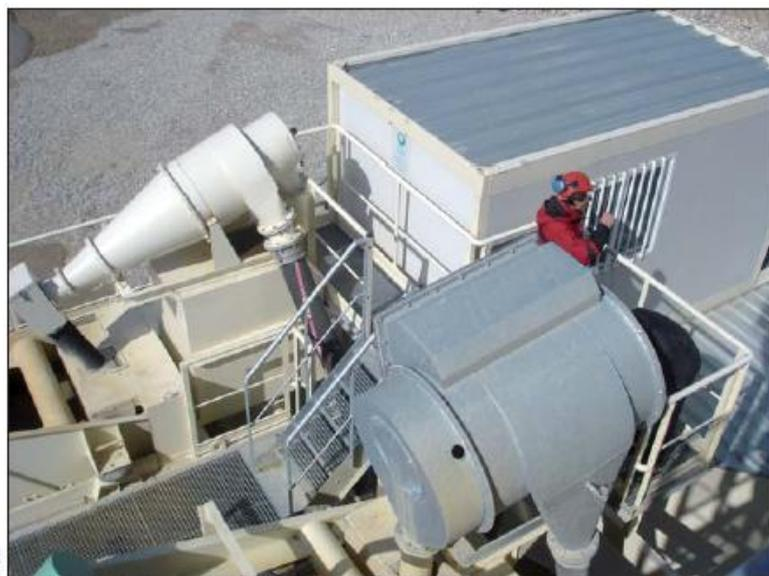
Installation MS, avec en gris (au premier plan), le module correcteur de courbe. Le lavage des matériaux nécessite un volume journalier de 2 000 m<sup>3</sup> d'eau, dont 250 m<sup>3</sup> pour le crible. L'appoint en eau du réseau varie entre 3,5 et 5 %. La boue est évacuée par pompage jusqu'aux fouilles de la carrière
